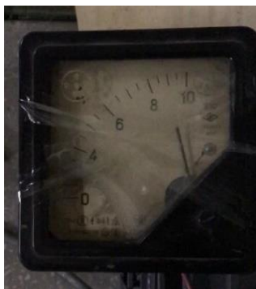
Рисунок 22 – Показания амперметра пуска главного привода без вспомогательного привода
